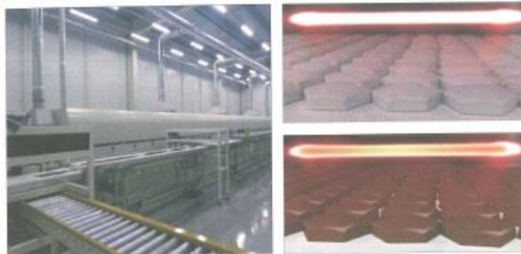
Слика 14. Печка за печење и процес на печење на турманиумот
